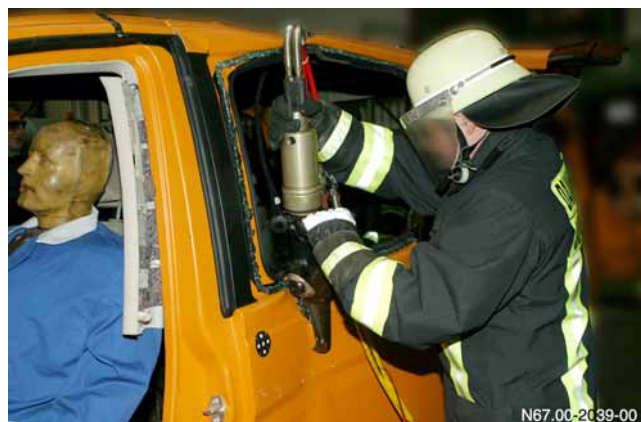
Einschneiden in die Fensterbrüstung rechts und links
