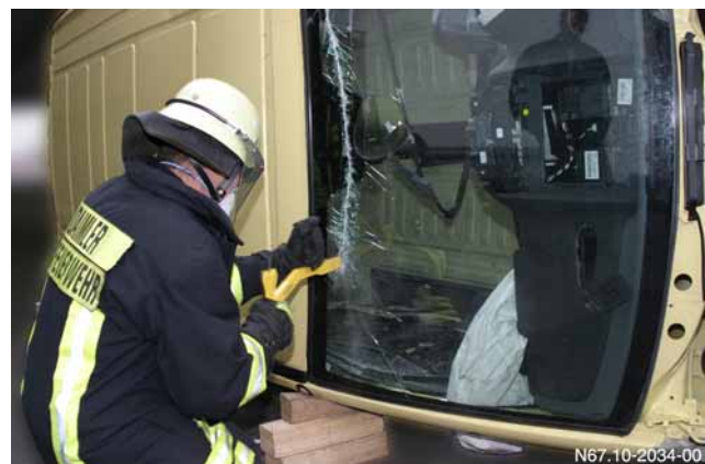
Aussägen einer Windschutzscheibe aus Verbundsicherheitsglas bei einem auf der Seite liegenden Transporter
