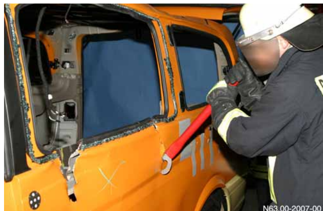
Setzen zweier Schnitte mit Hilfe des Blechreißers bis auf Höhe des Fahrzeugbodens
