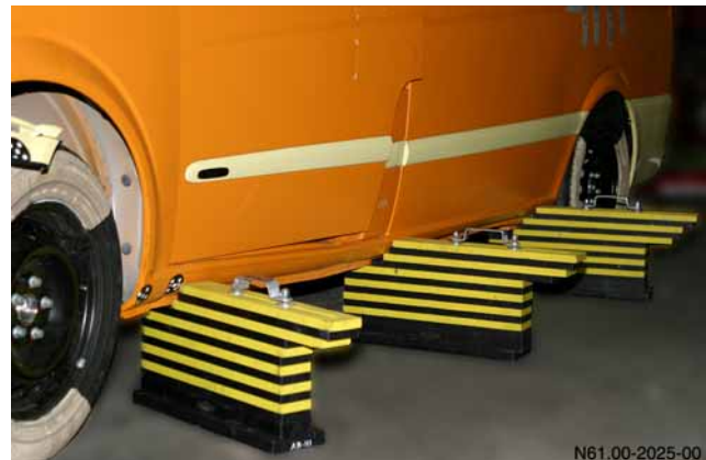
Unterbau eines Transporters an 3 Stellen pro Fahrzeugseite
