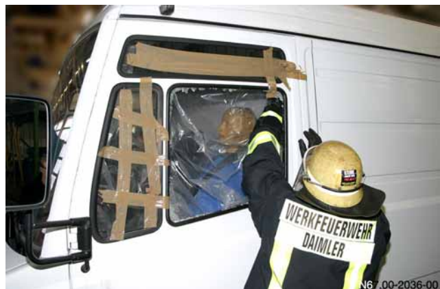
Arbeitsfolge zum Entfernen einer Seitenscheibe aus Einscheibensicherheitsglas
