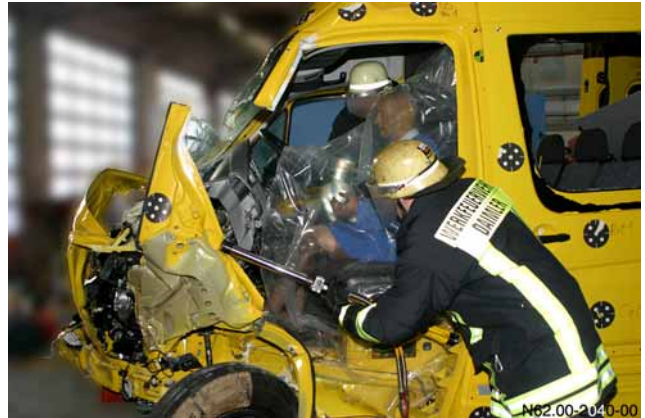
Einsatz des Rettungszyinders an A-Säule
