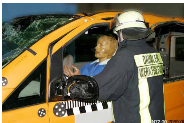
Erster Zugang zu den Insassen durch Fenster der Fahrertür
