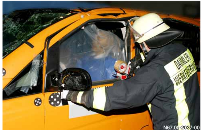
Abgeklebter Fensterspalt bei versenkter Scheibe
